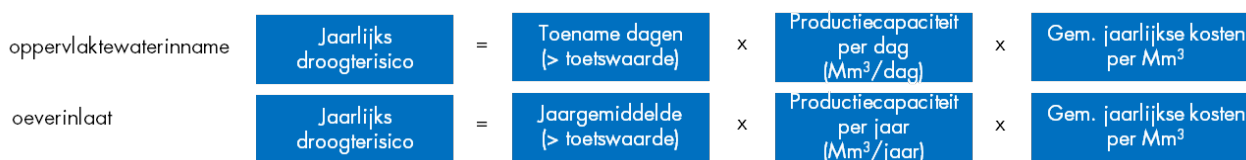
Figuur 14: schema berekeningswijze economische effect drinkwatersector uit hydrologische effect
